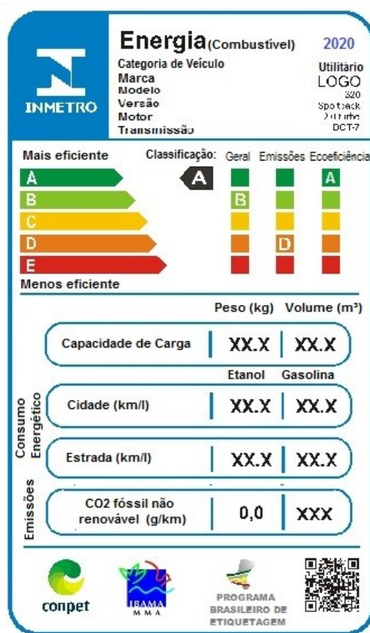
Figura 7 – Proposta de nova etiqueta incorporando o indicador de Ecoeficiência e as capacidades de carga para veículos utilitários.
